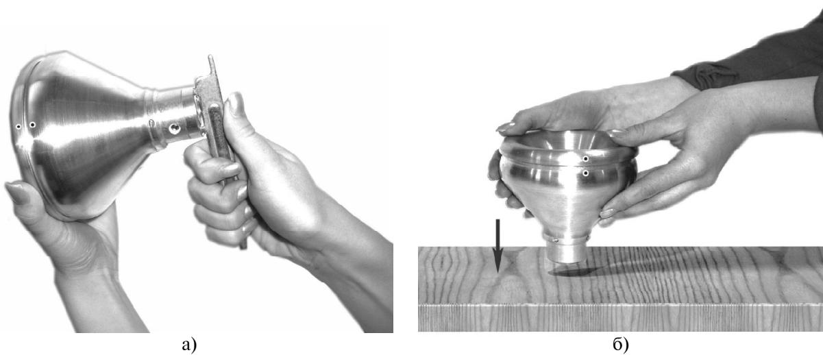
Рисунок 3 - Разборка барабана
