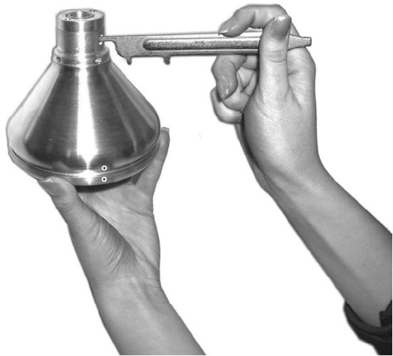
Рисунок 4 - Регулировка жирности сливок
