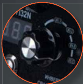
Регулировка силы тока по диаметру электрода
